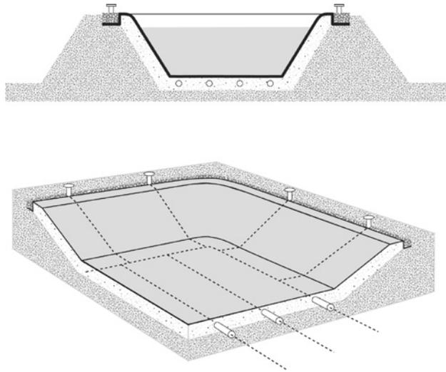
*Fig. 5 : Gas drainage*
