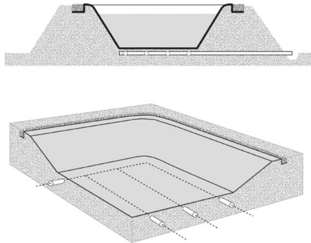
Fig. 4 : Water drainage
